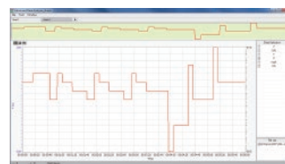
Fig. 2 DST Cycle Test
