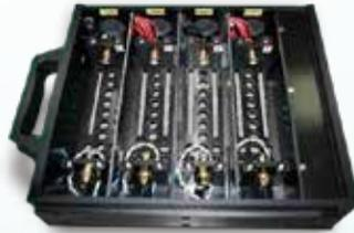
100A以下の円筒型陰極陽極ニッケルプレート電池に適用。
