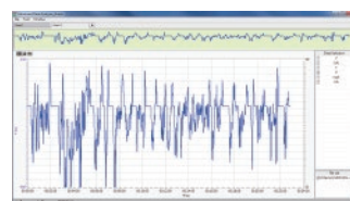
图 1 FUDS 测试功率曲线
